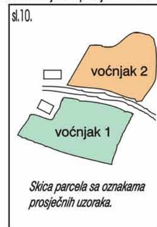
Sl.10. U koliko se želi ispitati zemljište sa više odvojenih parcela onda je potrebno, na opisan način, sa svake parcele uzeti po jedan prosječan uzorak i nacrtati skicu.
